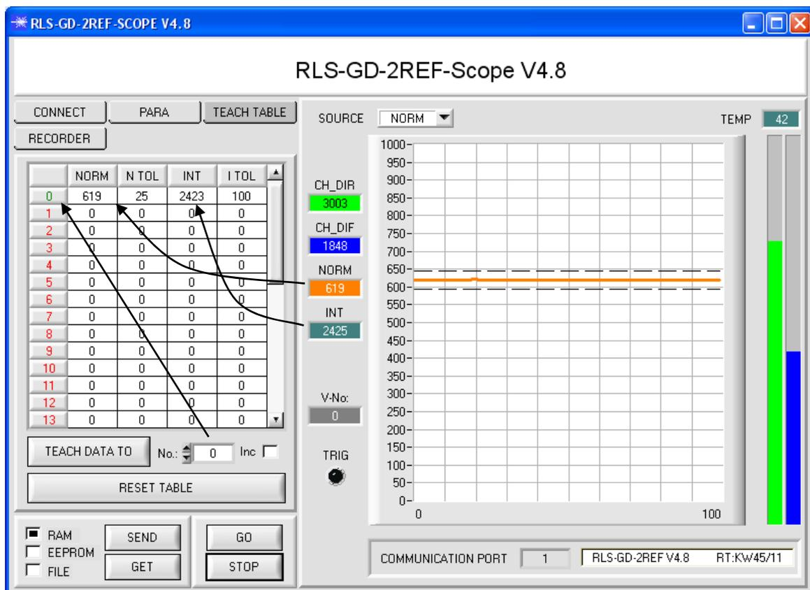
Drücken Sie die Taste **SEND**, um dem Sensor den gelernten Vektor mitzuteilen. Aktivieren Sie den **GO** Modus wieder. Wenn der Sensor einen Zeilenvektor wiedererkennt, wird die entsprechende Zeilennummer unter **V-No.:** auf der Software-Oberfläche visualisiert. 255 bedeutet, dass keine der gelernten Vektoren wieder erkannt wurde.
