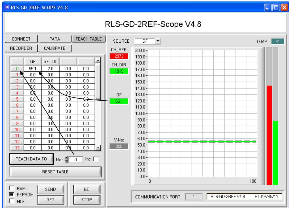
Drücken Sie die Taste **SEND**, um dem Sensor den gelernten Vektor mitzuteilen. Aktivieren Sie den **GO** Modus wieder. Wenn der Sensor einen Zeilenvektor wiedererkennt, wird die entsprechende Zeilennummer unter **V-No.:** auf der Software-Oberfläche visualisiert. 255 bedeutet, dass keiner der gelernten Vektoren wieder erkannt wurde.
